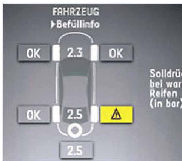
Figur 16. Däcklufttrycks kontroll övervakning från fordonets instrumentpanel.
