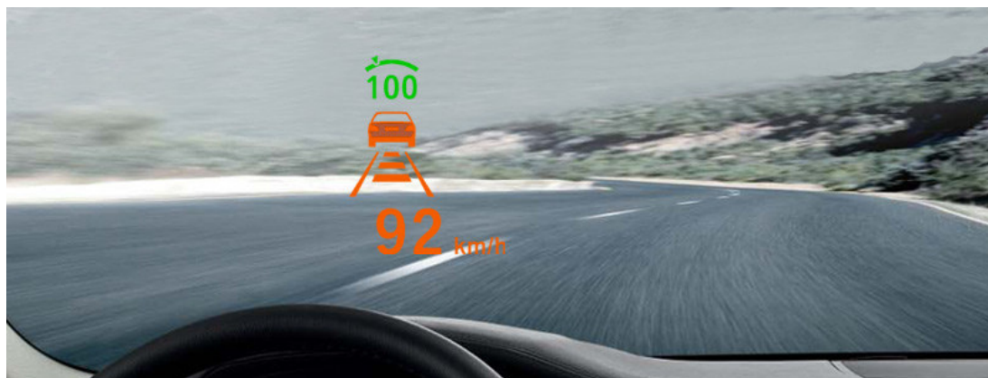
Figur 8. Adaptiv farthållare med head-up display. Källa: http://www.bmw.com .
