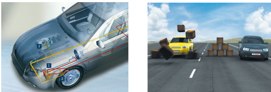
Figur 17. ABS principskiss och demonstration av styrförmåga vid undanmanöver med och utan ABS. Källa: http://www.bosch.com .
