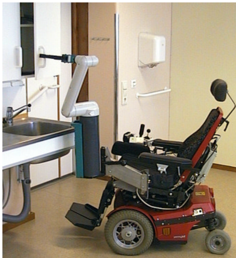
Bild 10. Manus-armen monterad på en rullstol.
