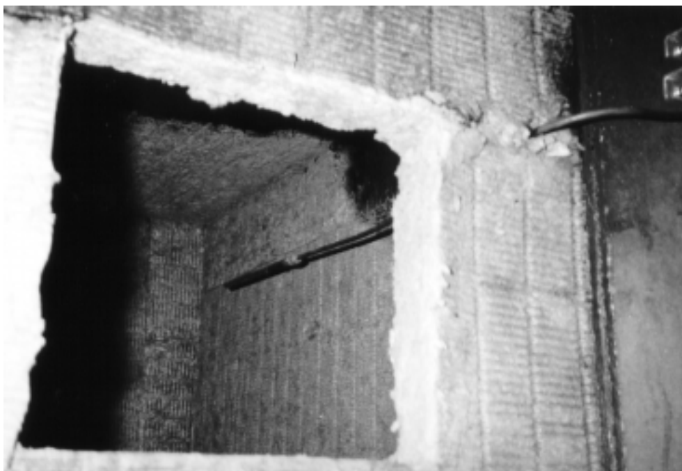
Figur B.3, Probens placering i förbränningskammaren som den var i de flesta försöken. Fotot taget snett underifrån genom öppningen /B.2/.
