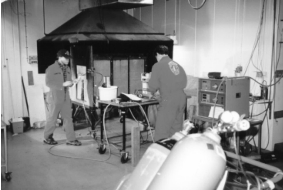
Figur B.1, Försökuppställningen för metanförsöken. Förbränningskammaren ses i bakgrunden under huvan och analysinstrumenten till höger /B.2/.
