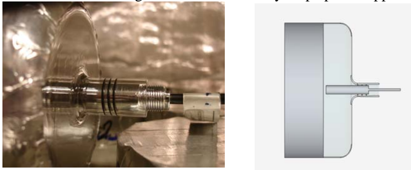
Figur 24. Till vänster fotografi av provkropp med vaisalaser fixerad till glaskupa med tre o-ringar, till höger principfigur i genomskärning.
