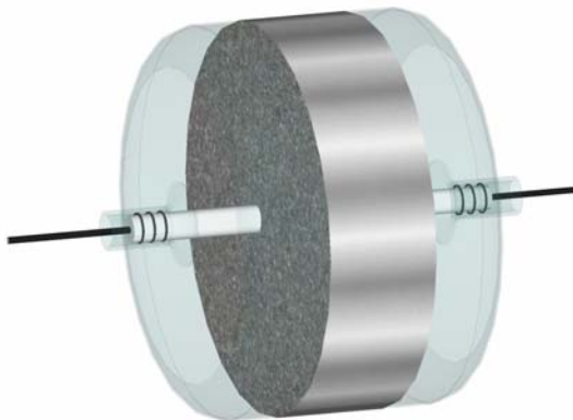
Figur 31. Provkropp med två glaskupor fixerade på basytorna. En vaisalasektor är fixerad med tre o-ringar i vardera glaskupa.
