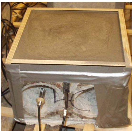
Figur 2.2.1 En HD/F-provkropp med mätpunkter för RF och "invallning" på överytan för simulering av regn och senare avjämning.
