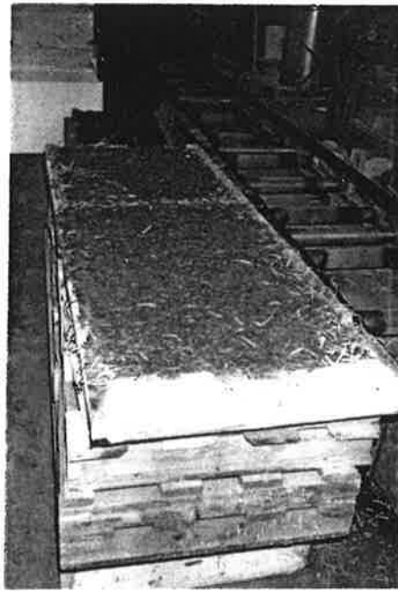
Fig. 3.2.4. On a pressé la laine avec un poids placé dans le moule (à gauche). L'image de droite montre le panneau après 24 heures dans le moule. Au bout de trois jours on l'a démoulé.
