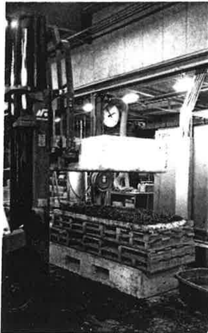
Fig. 3.2.4. On a pressé la laine avec un poids placé dans le moule (à gauche). L'image de droite montre le panneau après 24 heures dans le moule. Au bout de trois jours on l'a démoulé.
