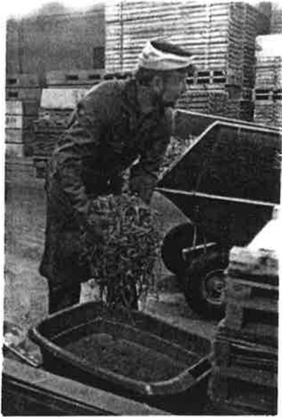
Fig. 3.2.3. On a trempé la laine dans une laitance de ciment (à gauche) puis on l'a répartie dans un moule (à droite). Celui-ci est rempli à environ le double de sa hauteur.
