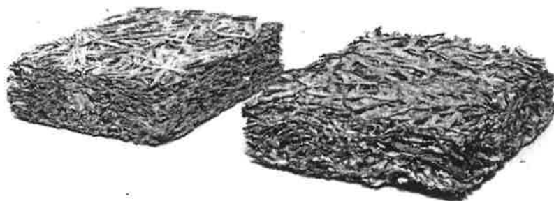
Fig. 3.2.1. Exemples de panneaux en laine de bois (épaisseur : 5 cm). A gauche fabrication industriel (bois de sapin), à droite fabrication manuel (bois d'eucalyptus Algérien).
