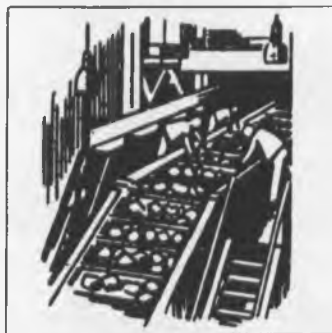
Leseband (lese-band) nastro trasportatore per la cernita (nastro trasportatore per la tchernita) transporter za biranje kamena seçmebandı
