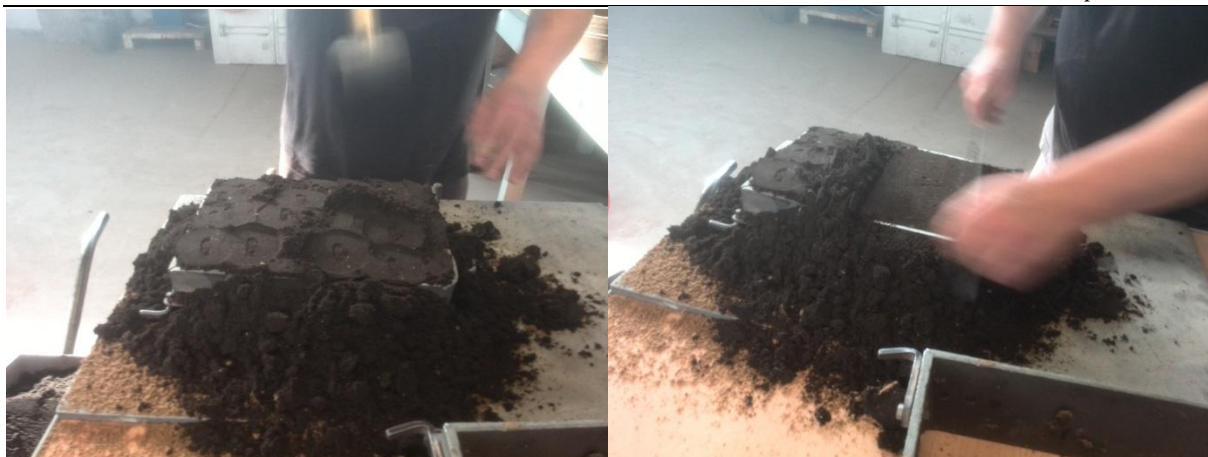
Slika 55. Sabijanje i poravnavanje punidbene kalupne mješavine donjaka
