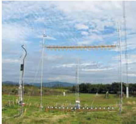
*Messeinrichtung aus optischen Glasfasern auf einer Forschungsfläche in Corvallis, Oregon/USA. Eine Weiterentwicklung dieser Technologie wird es künftig ermöglichen, neben der Lufttemperatur und der Windgeschwindigkeit auch die Windrichtung exakt zu ermitteln. Dann lässt sich über Hunderte von Metern eine volle dreidimensionale Beschreibung der Luftströmung und des Wärmetransports in bislang unerreichter Auflösung realisieren.*
