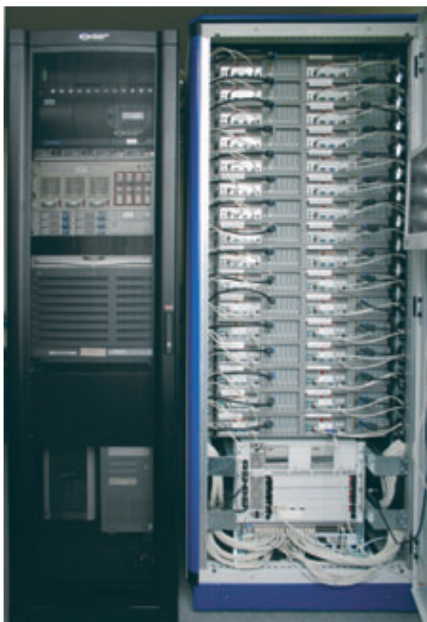
Abb1: Ein Rechnercluster, bestehend aus 32 Rechnern mit je zwei Prozessoren zur Untersuchung der effizienten Hardwareausnutzung am Beispiel der Computergrafik
