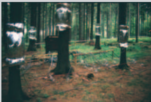
Messung des Wassertransports in Fichten während der Verdunstung
