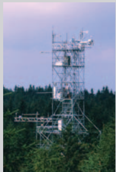
Der Turm für Messungen im und über dem Pflanzenbestand
