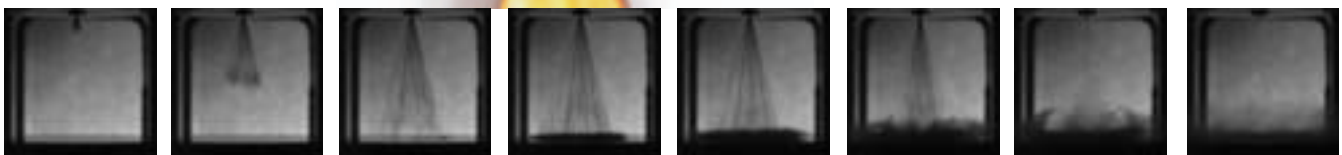
Abbildungsreihe: Hochgeschwindigkeitsaufnahmen einer Spray-Wand-Wechselwirkung in einer Spraykammer
