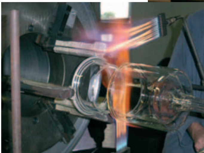
Glasbearbeitung an der Drehbank (unten links) und von Hand (unten rechts)
