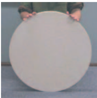
Bild 4: Al 2 O 3 -Keramikbauteile in einem kontinuierlichen Mikrowellenofen gesintert (M. Sato et al. vorgestellt in Loughborough, UK, 2003)
