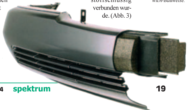
Abbildung 2: Stoßstange in Kunststoff-Sandwich-Bauweise.
