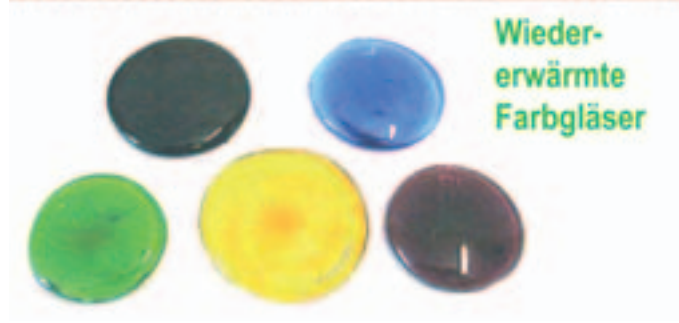
Bild 3: Mikrowellenerwärmung von Silikatglas bis zur Schmelztemperatur
