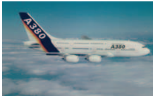
Abbildungen 5: Innenraum und Modell des neuen Airbus A380. Großraumflugzeugs mit CFK Seiten- und Höhenleitwerk.
