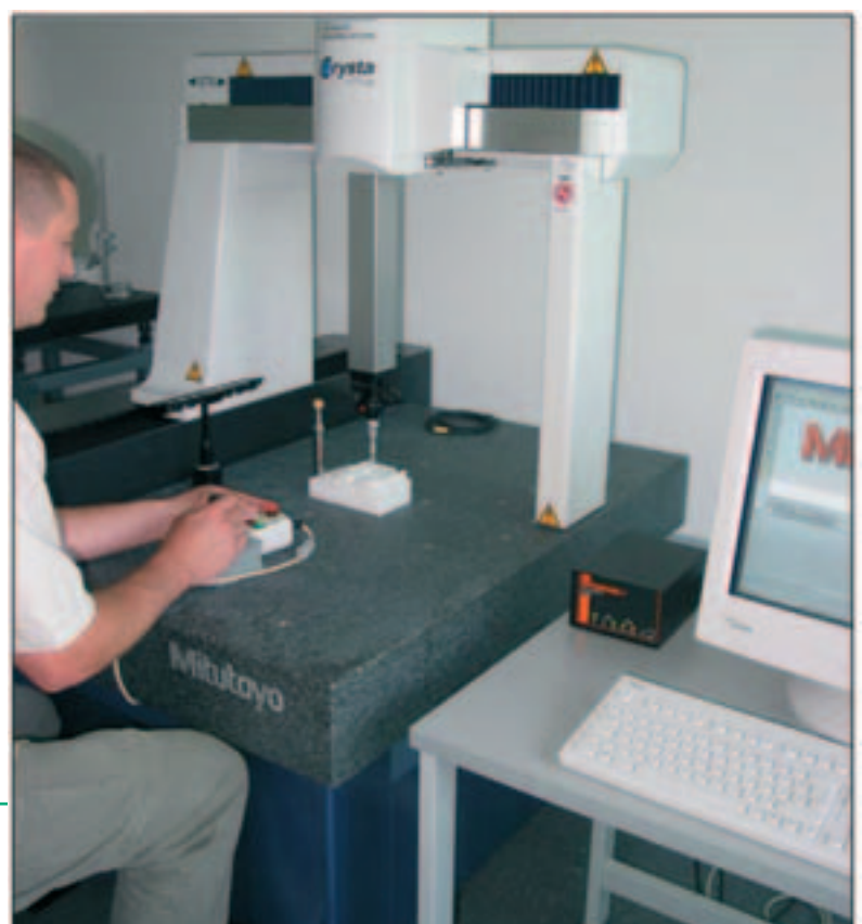
Abbildung 3: 3D-Koordinatenmesstechnik zur Qualitätssicherung im Remanufacturing.
