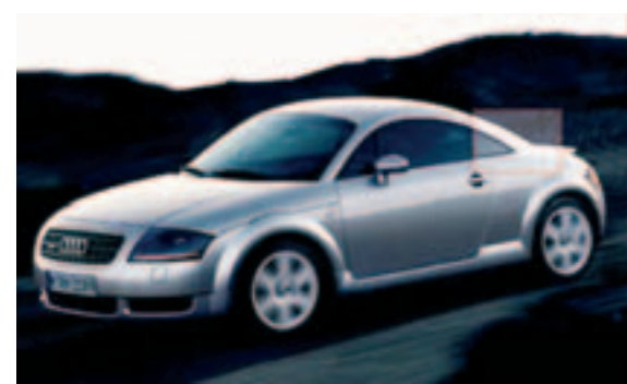
Abbildung 3: Aluminium-Dach verbunden mit Stahl-Kotflügel, Demonstratorbauteil für den AUDI TT.
