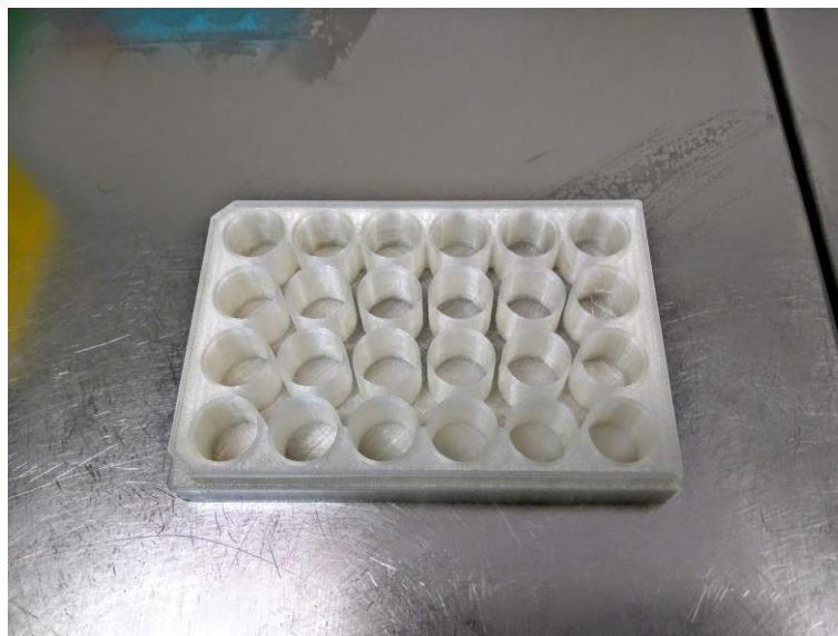
Figure 66 Plaque de culture 24 puits imprimée en acide polylactique (PLA) avec l'imprimante 3D Ultimaker 2
