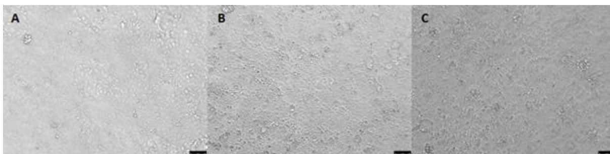
Figure 40 Test de biocompatibilité sur les composants du Cellware Hepia (A) Croissance cellulaire sur la colle EPO-TEK® de chez EPOXY TECHNOLOGY après 4 jours ; (B) Croissance cellulaire sur le scotch 3M 467MP 200MP Adhesive après 4 jours ; (C) Croissance cellulaire contrôle après 4 jours ; Ensemencement 114'300 cellules/cm 2 ; Echelle 75 µm
