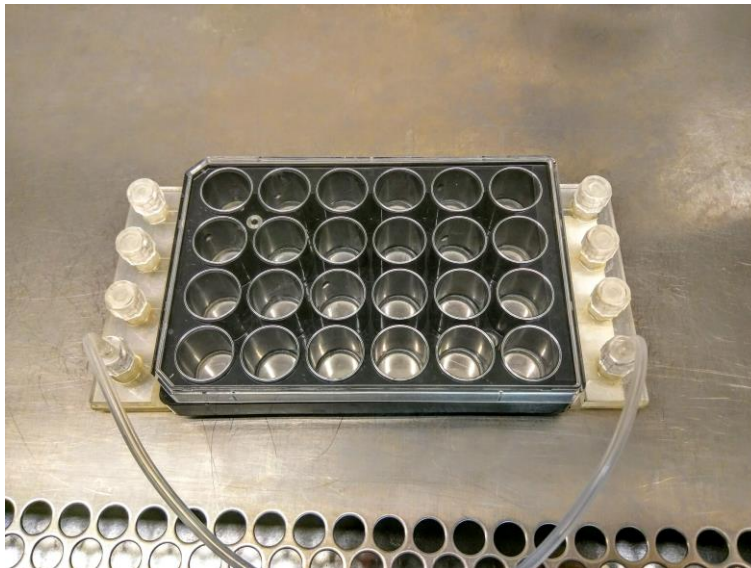
Figure 64 Cellware Hepia intégrant de la fluidique. Plaque 24 puits composée d'une électrode inférieure et un système de canaux horizontaux entre les puits.
