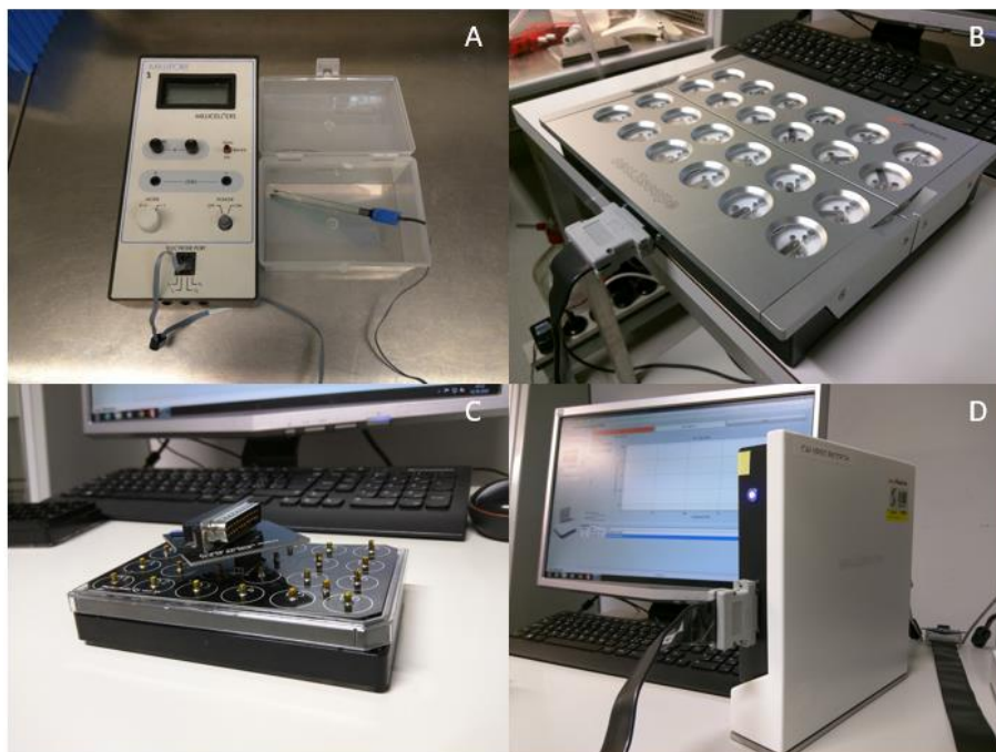
Figure 17 Imagerie des différents systèmes de mesure de l'impédance : (A) Millicell (Millipore) avec l'électrode type chop stick ; (B) Cellware du CellZscope (NanoAnalytics) ; (C) Cellware Hepia avec le connecteur pour l'électronique du CellZscope ; (D) Electronique du CellZscope avec spectre d'impédance sur l'écran d'ordinateur
