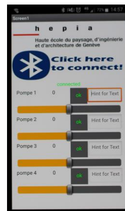
Figure 19 Interface de l'application PMI permettant le contrôle des pompes péristaltiques
