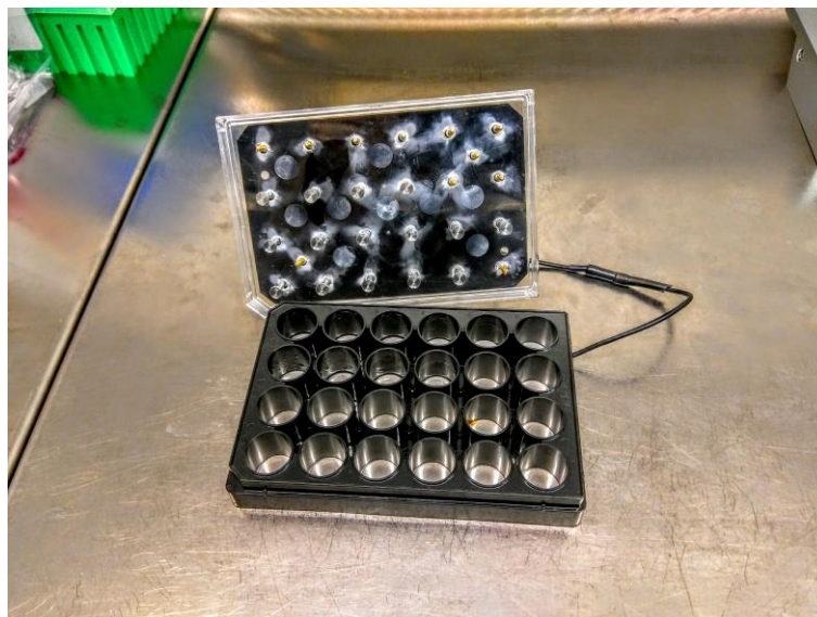
Figure 62 Cellware Hepia (24 puits) avec mesure de la bioimpédance. Dans cette version, l'électrode du bas est reliée à l'électronique par une câble.
