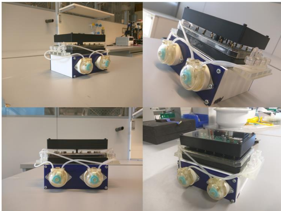
Figure 70 Impédancemètre complet avec fluide et système à deux pompes péristaltiques : Pompes péristaltiques; Cellware Hepia avec fluide et Hardware Hepia
