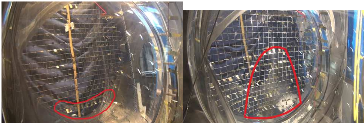
Abb. 4.23: Fäden im Krümmer, links: 2 cm hinter der Umlenkung, rechts: Übergang Steigrohr/Krümmer
