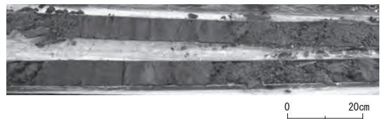
図60 掘削によって得られたボーリング試料 (津島東2コア)
