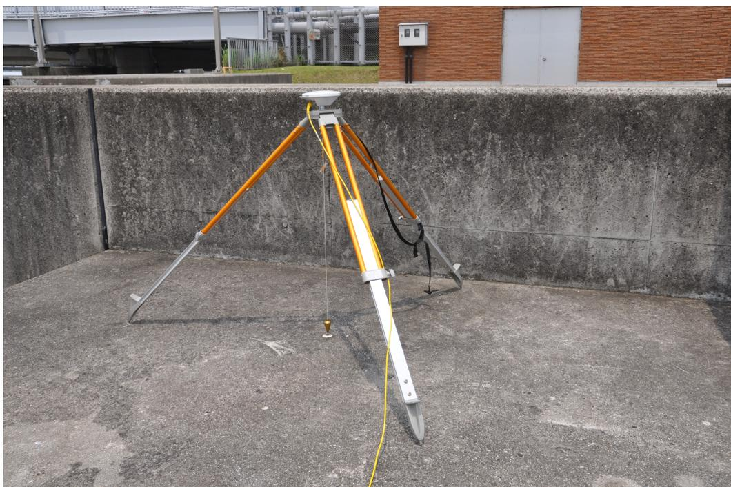
図 2.3: 児島湾中央管理事務所の管理棟西側に設置基準局, 平成 28 年 6 月 20。2016 年 11 月からは電子基準局を用いて測位-測深計測を行った [20]。
