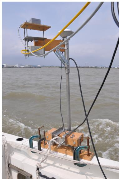
図 2.5: 方位計, 傾斜系および RTK-GPS アンテナ 平成 28 年 6 月 20 日
