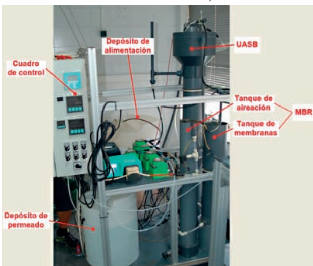
Imagen 7. Planta piloto de un sistema combinado UASB+MBR para el estudio de la eliminación de contaminantes emergentes (Laboratorio del Instituto Universitario del Agua y de las Ciencias Ambientales de la Universidad de Alicante)
