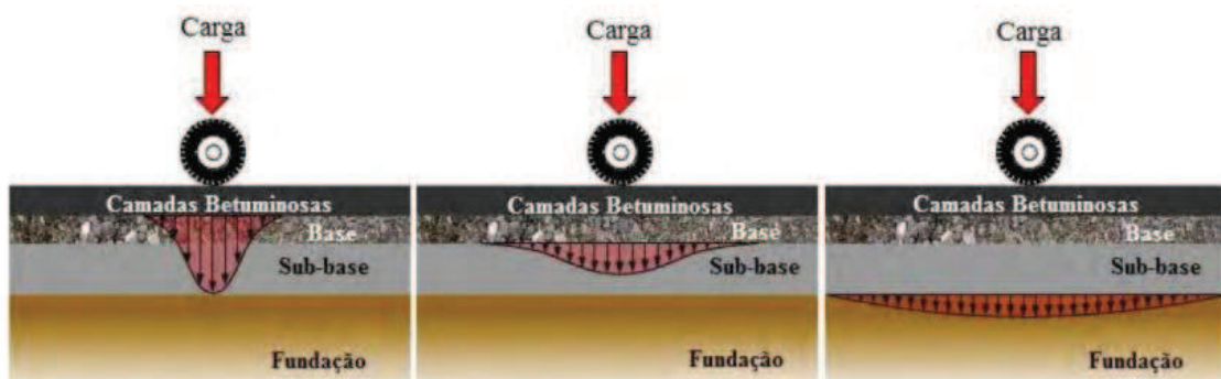
Figura 16. Transmissão das cargas nas diversas camadas de estrutura de pavimento.
