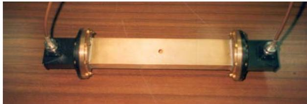
**Figuras 3.4 e 3.5** – Cavidade ressonante rectangular de 5 GHz.
