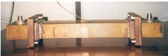
**Figura 3.7** – Cavidade ressonante rectangular de 2,45 GHz.
