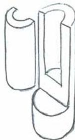
**Figura 3.27** – Esquema de um porta amostras em corte longitudinal.
