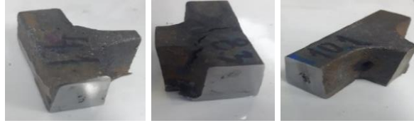
Figura 3.12 - Amostras polidas para visualização no microscópio ótico.
