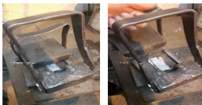
Figura 3.6 - Obtenção de uma medalha para determinação da composição química do fundido.
