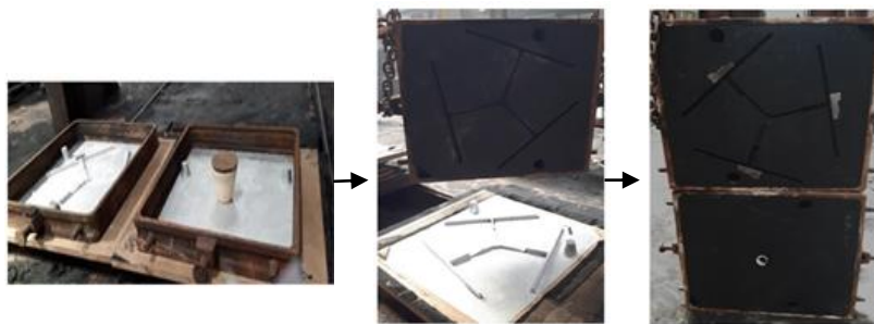
Figura 3.3 - Etapas realizadas para a obtenção da moldação em areia auto-secativa.
