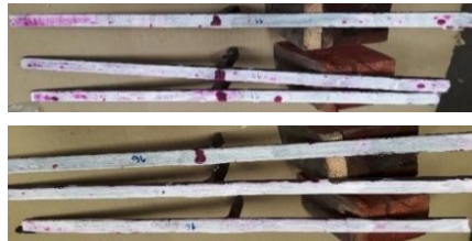
Figura 3.8 -Algumas peças sujeitas ao ensaio de líquidos penetrantes.
