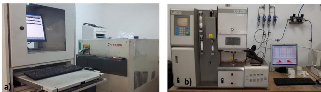
Figura 3.7 – a) Espectrómetro de emissão ótica; b) Leco.
