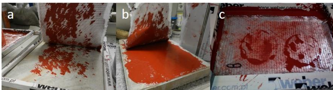
Figura 12 - Modo de incorporação da fibras de vidro na membrana polimérica para se perceber qual a melhor forma de incorporação da mesmas: a) camada inicial de membrana 0,5mm; b) camada inicial de membrana 1mm; c) camada inicial 1mm mas com segunda camada aplicada no dia seguinte.
