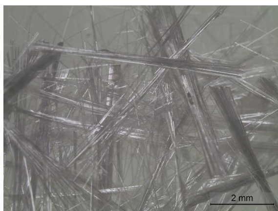
Figura 7 - Fibras de vidro cortadas com 6mm de comprimento.
