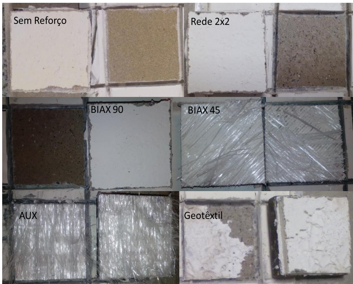
Figura 17 - Provetes resultantes dos ensaios de aderência antes dos ciclos gelo-degelo.
