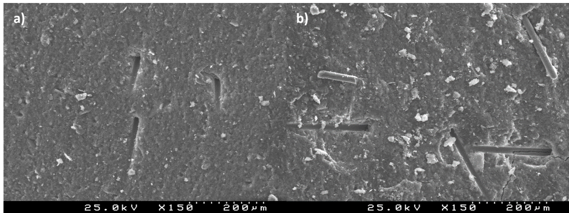
Figura 51 - Imagens obtidas por SEM das amostras sujeitas a compressão após 28 dias de cura; a) 0,20% fibra de vidro; b) 1,00% fibra de vidro.
