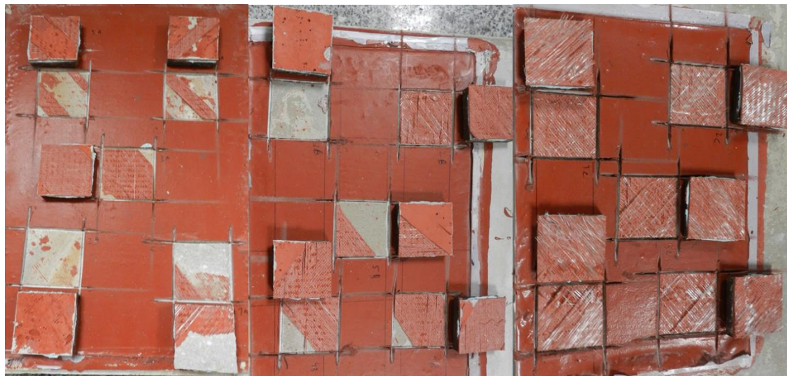
Figura 15 - Ilustração do estado final dos provetes após o ensaio de aderências. A sequência das imagens (da esquerda para a direita caso) corresponde às amostras preparadas de acordo com a metodologia A, B e C.
