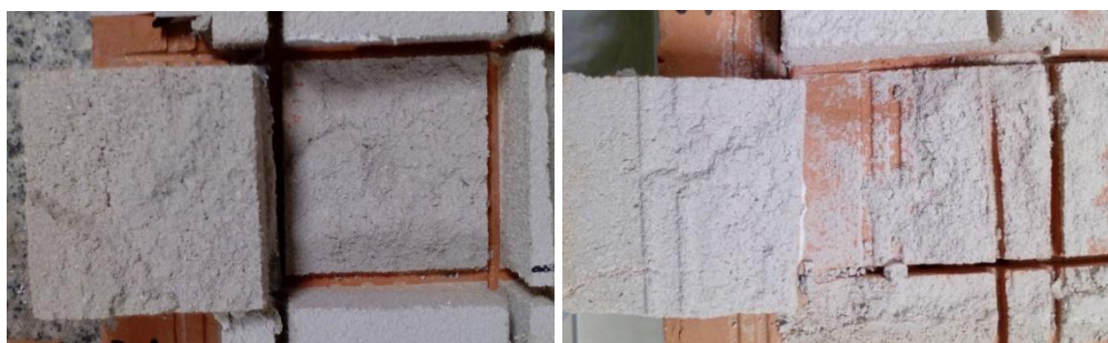
Figura 25 - Tipo de rutura apresentada pelas amostras após os testes de aderências: à esquerda a amostra padrão, à direita a amostra com fibras de vidro.
