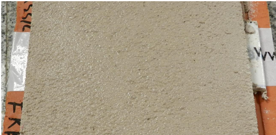
Figura 21 - Estado das amostras submetidas ao ensaio de fissuração plástica após um dia de cura; A) amostra padrão, B) amostra com fibras de vidro.
