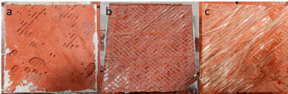
Figura 14 - Provetes após o teste de aderência, permitem ver o efeito de se aplicar a membrana polimérica com diferente intervalo temporal.
