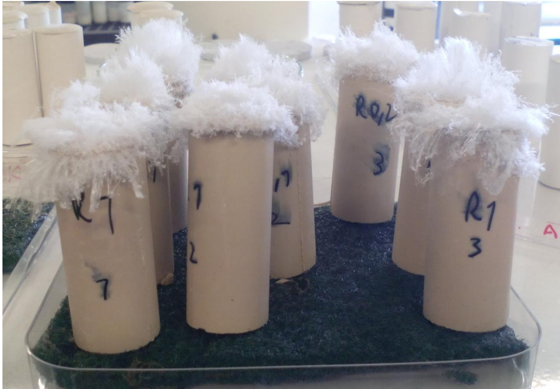
Figura 45 - Amostras de geopolímeros com efluorescências após absorção de água por capilaridade.
