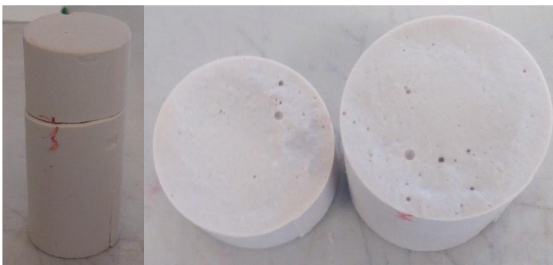
Figura 44 - Provete fraturado após imersão em água.
