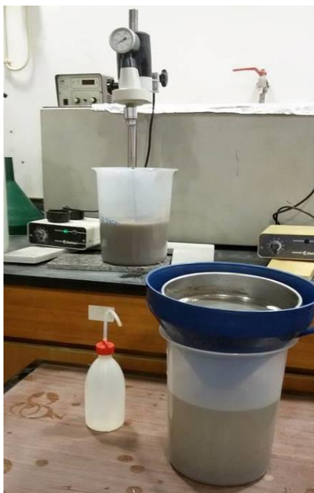
Figura 4. 3. Distribuição dos materiais usados na separação granulométrica por via húmida. Parte da amostra no agitador mecânico e outra parte num recipiente com um funil e peneiros de malha 63 \mu\text{m} .
