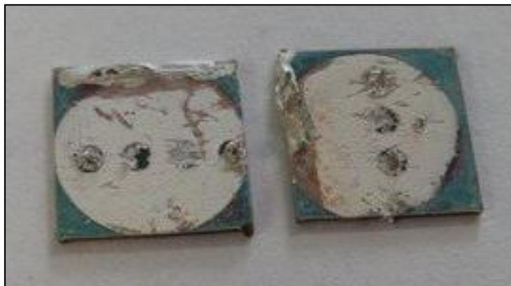
*Figura 44-Filmes de nanobastonetes de SnO<sub>2</sub> destruídos após tentativas de fixação de fios condutores ao eléctrodo depositado na amostra.*
