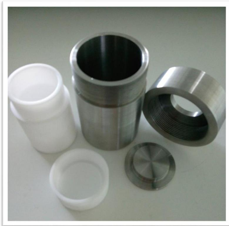
*Figura 17- Autoclave a e interior de Teflon para síntese hidrotermal.*
