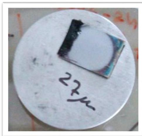
*Figura 24-Filme de SnO<sub>2</sub> depositado num substrato de aço para visualização em SEM.*
