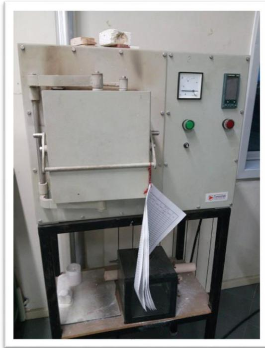
*Figura 23-Forno utilizado na sinterização dos filmes a 500 °C durante 2 h, com um aquecimento e arrefecimento gradual de 10 °C/min.*
