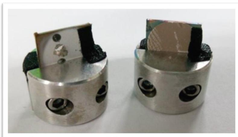
*Figura 25-Filmes de SnO<sub>2</sub> depositados por deposição eletroforética para visualização da sua estrutura em secção transversal.*
