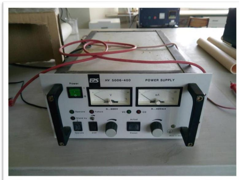
Figura 22- Equipamento utilizado para deposição eletroforética.
