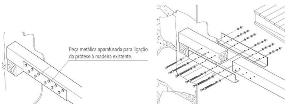
Figura 3.16 – Pormenor da ligação da chapa à viga de madeira (Cóias, 2007).
