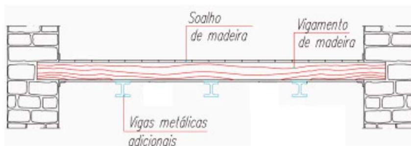
Figura 3.21 – Vigas metálicas adicionais (Baião et al., 2012).
