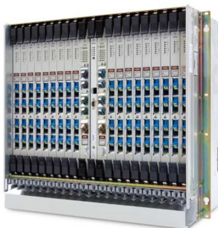
Figura 65 – GPON OLT Alcatel-Lucent 7342 ISAM FTU
