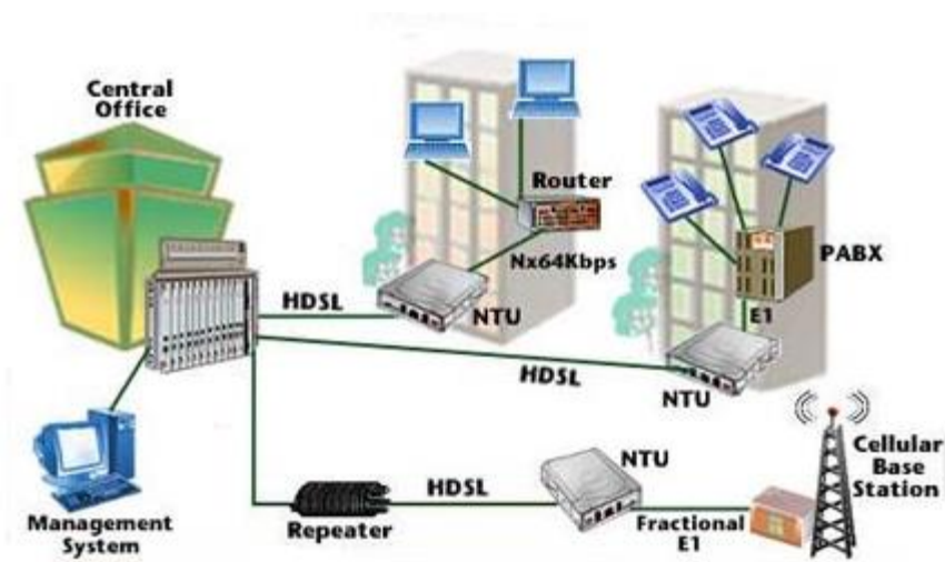
Figura 16 – Arquitectura de rede utilizando a tecnologia HDSL [12]
