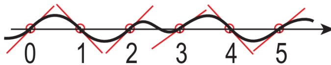
Joonis 16. Ühemõõtmelise Perlini müra korral konstrueeritav funktsioon [16].
