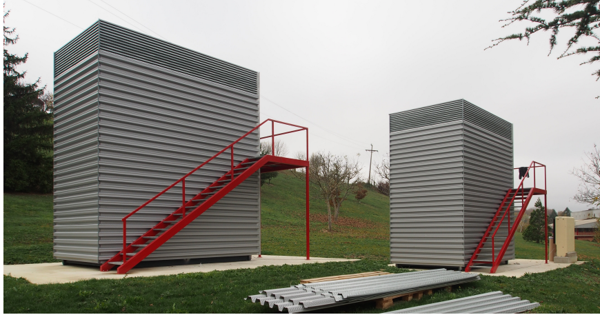
Figura 6: Fotografía de los dos prototipos de ensayo. El prototipo 2.0 (derecha) dispone de un sistema de climatización convencional y una fachada ventilada sin control y el prototipo 2.1 (izquierda) dispone del nuevo sistema de climatización Peltier y control de la cámara de aire
