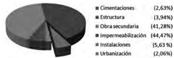
Fig. 1. Origen de la siniestralidad en edificios destinados a viviendas¹
