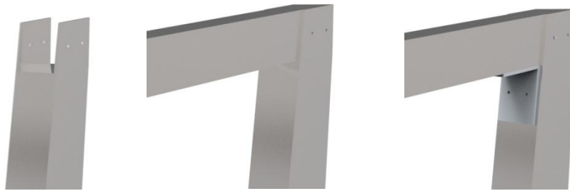
Img.35. Unión entre vigas .
