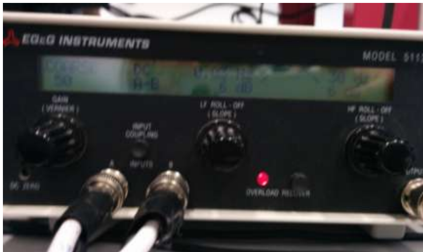
Ilustración 18: En la imagen se muestra la configuración seleccionada para la realización de las pruebas. A la izquierda del LCD, se muestra la ganancia, que va a ser de 50. A continuación, se muestra A-B, que va a ser el tipo de entrada de la señal. Por último, se muestra la configuración del filtro, concretamente un es un filtro pasa-banda de 0.03Hz a 30Hz.
