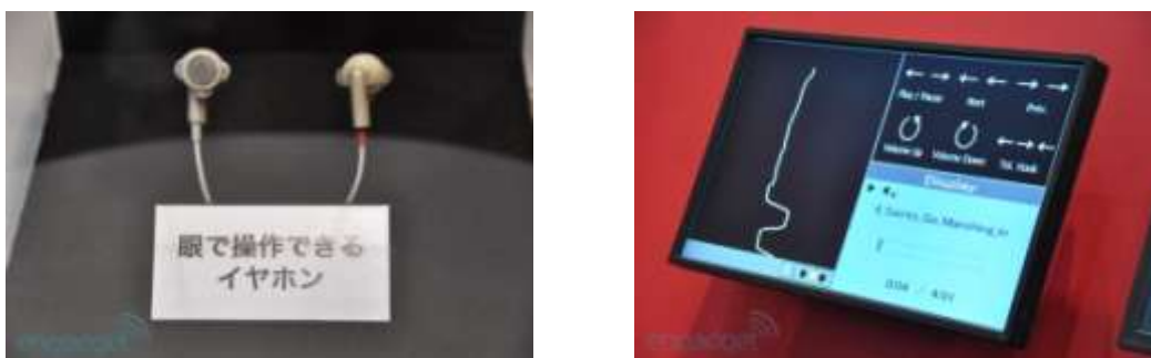
Ilustración 8: En la imagen de la izquierda se pueden observar los auriculares fabricados por DoCoMo que permítela detección del movimiento ocular. La imagen de la derecha representa la señal obtenida y las diversas funciones que pueden realizarse mediante el movimiento, tales como aumentar el volumen, cambiar de canción, etc.
