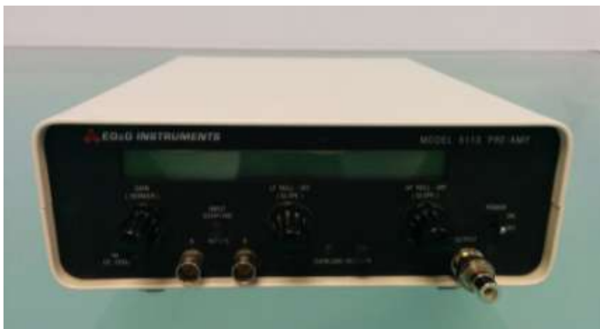
Ilustración 17: Amplificador de la casa EG&G Instruments, modelo 5113 Pre-Amp. Utilizado para la obtención de la señal proveniente de la diferencia de potencial de los ojos amplificada, realizar una diferencia entre ambas señales y filtrar la señal entre unos rangos dados.
