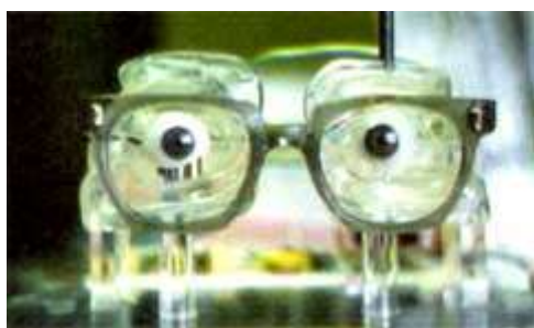
Ilustración 9: Ojos artificiales situados en las cuencas de plástico, junto con las gafas para la detección del movimiento ocular del ojo natural.
