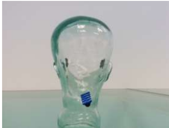
Ilustración 11: Localización del electrodo que actuará de tierra, concretamente en la nuca.
