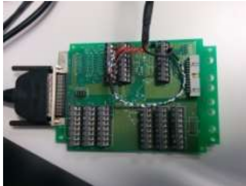
Ilustración 21: Placa utilizada para realizar conexiones entre la tarjeta digitalizadora y el amplificador utilizado.
