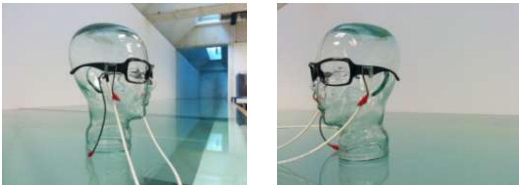
Ilustración 15: La imagen de la izquierda muestra la visión lateral derecha de las gafas. Como se puede apreciar, tiene un cable coaxial conectado a la patilla de las gafas, del cual, van a salir dos cables, por una parte, el cable que va a conectarse al lateral del ojo, y por otra parte, el cable que estará conectado al electrodos de la nuca (tierra). Por otra parte, la imagen de la derecha muestra la visión lateral de la izquierda de las gafas, en el cual se puede ver que únicamente está conectado un cocodrilo, el cual se conectará al lateral de este ojo.
