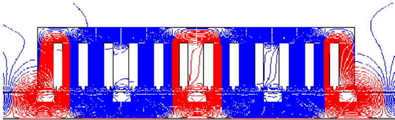
Figura 3.2: Líneas de flujo en un motor lineal
