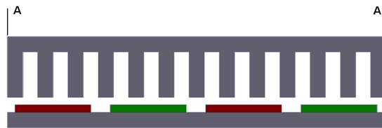
Figura 2.13: Motor lineal síncrono obtenido del desarrollo del motor rotativo.
