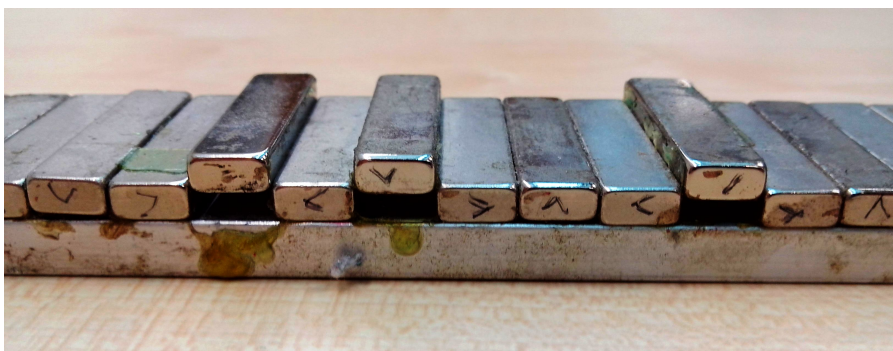
Figura 6.10: Problemas en el secundario con imanes en Halbach.
