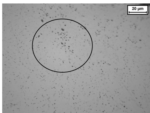
Figura 4 - 14. Segregaciones sin alineación de MnS para el acero AISI 303
