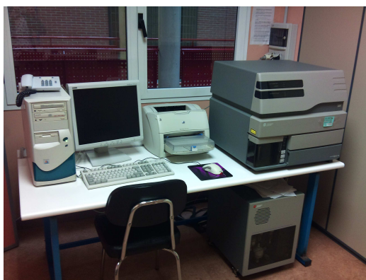
Figura 97: Citómetro de flujo Coulter Epics XL 4-CLR utilizado en los estudios de muerte celular.
