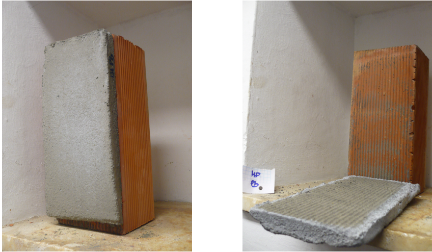
Figura 9: Ensayo de extendido sobre ladrillo.
