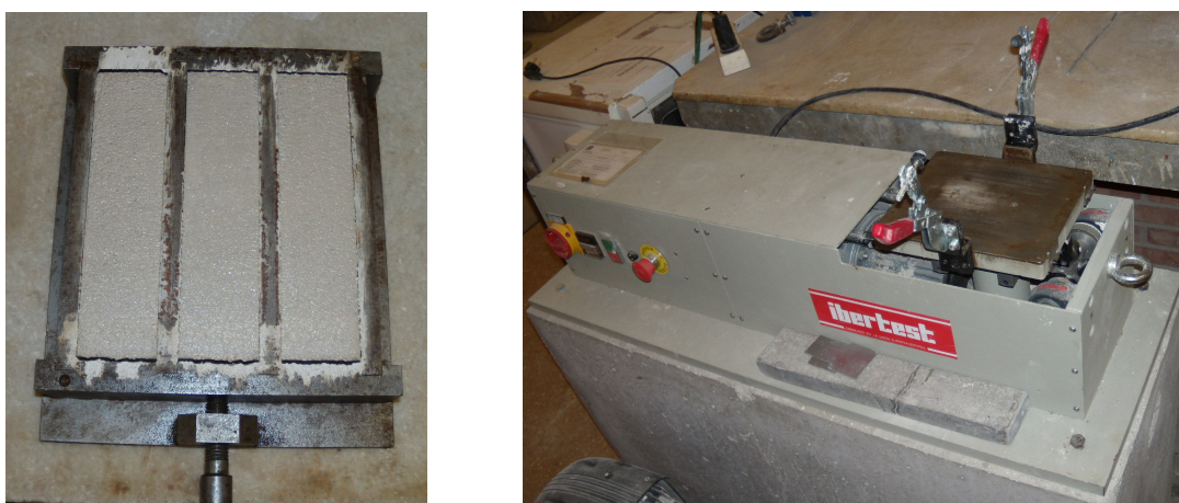
Figura 10: Moldes de acero para las probetas y compactadora automática.
