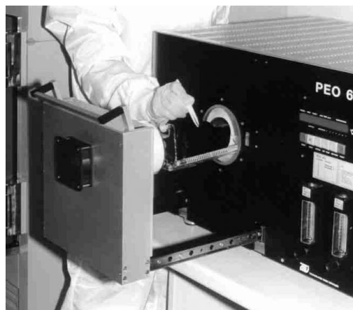
Figura 4.10 Horno de tratamientots térmicos PEO 601
