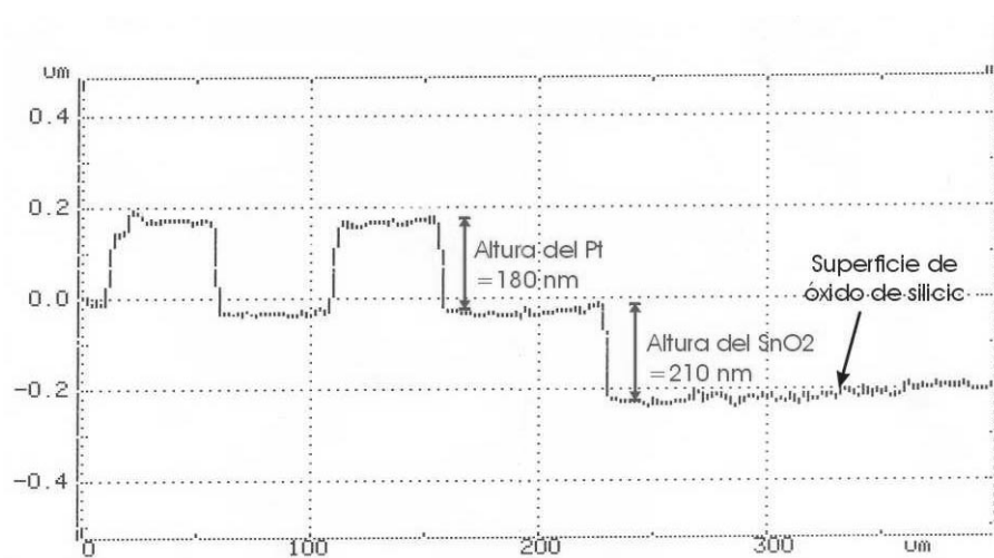
Figura 5.5 Perfil transversal del espesor depositado de platino y óxido de estaño en una de las muestras de test
