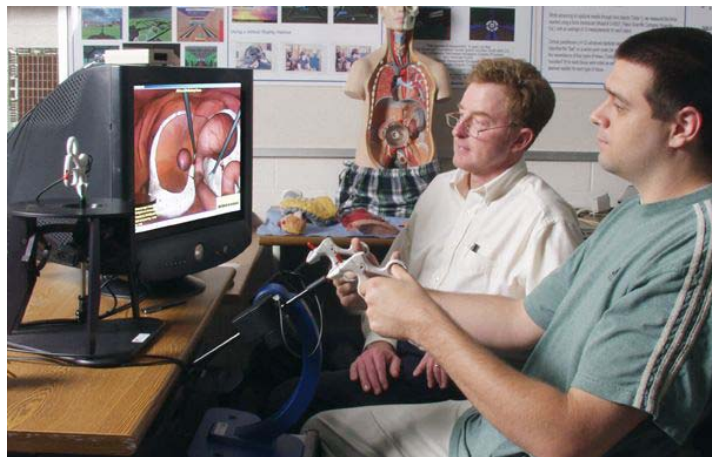
Figura 1.7 Sistema de entrenamiento de operaciones laparoscópicas
