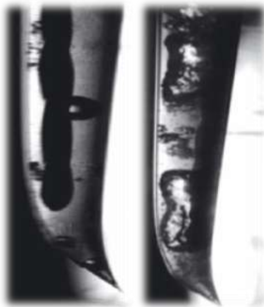
Ilustração 4 - Fenómeno de cavitação produzido por ponta ultrassónica ao início da activação (esquerda) e a alta rotação (direita). Imagens reproduzidas de van der Sluis et al. , 2007
