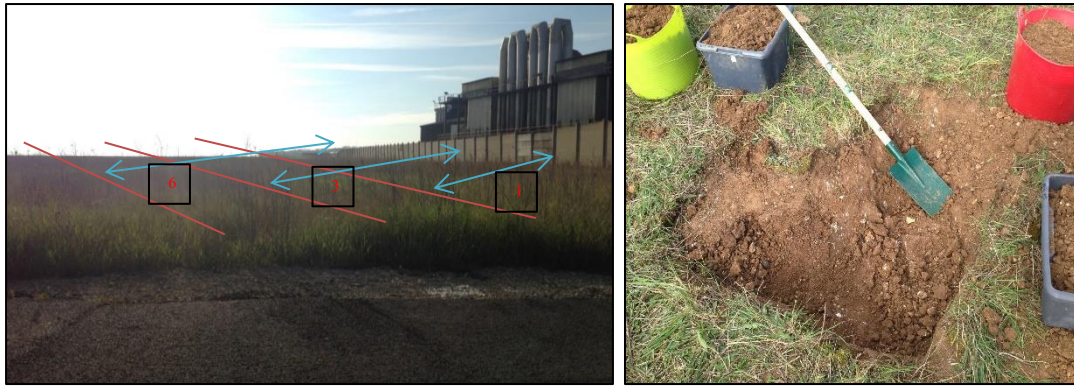
Figure 10 : Echantillonnage à trois distances 10, 30 et 60 m de l'usine et trois profondeurs 0-5, 5-17 et 17-30 cm.
