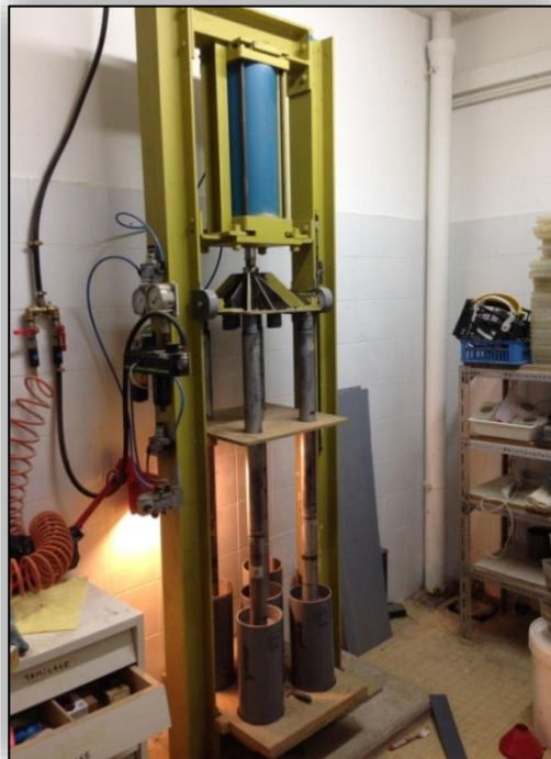
Figure 11 : Reconstitution de sol avec la presse hydraulique
