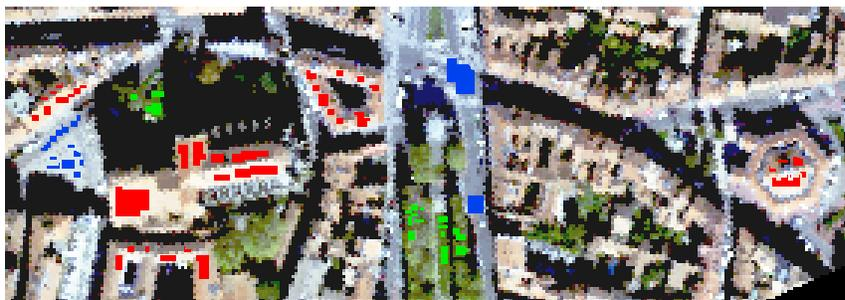
FIGURE 2.3 – Zone sélectionnée pour l'étude de l'hypercentre de Toulouse à une résolution de 1.8m avec en couleur les zones sélectionnées pour l'extraction des spectres purs. Rouge : Tuile, Vert : Végétation, Bleu : Asphalte).
