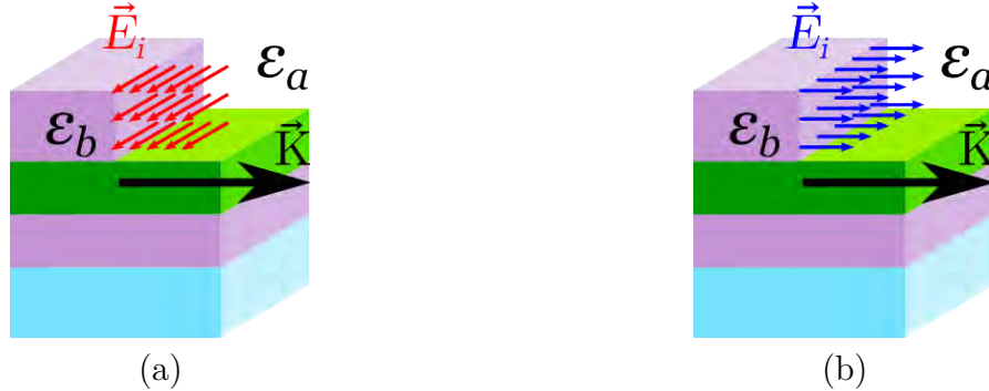
Figure 1.2 – Représentation graphique de la biréfringence sous l'incidence normale ( \theta_i = 0^\circ ) : (a) pour la polarisation \vec{s} avec moyenne géométrique \epsilon_{\perp} et (b) polarisation \vec{p} avec moyenne harmonique \epsilon_{//} .
