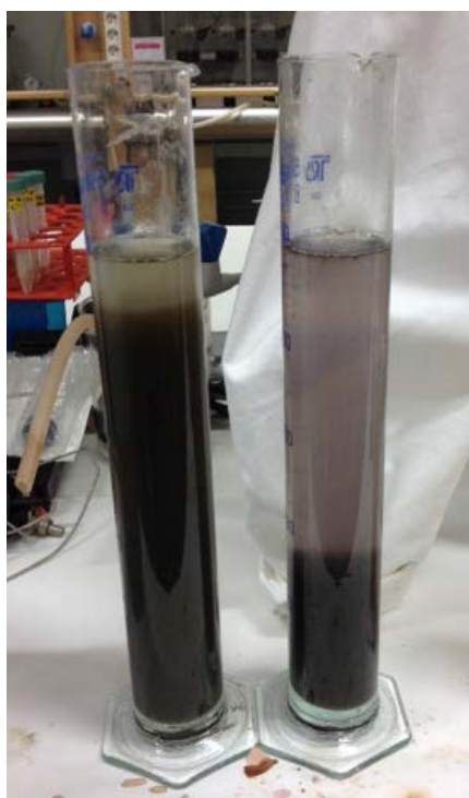
Figur 6. Flockning/koagulering i kommunalt avloppsvatten med tillsats av 100 ppm katjoniserade tanniner (höger), kontroll utan tanniner (vänster). Bilden visar effekten efter sju minuter.
