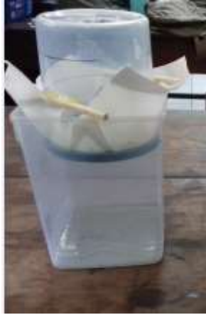
Gambar 14. Pembuatan penyaring sederhana.
