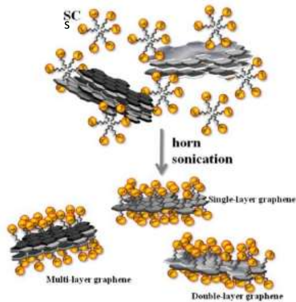
Gambar 1. Peran surfaktan pada metode LE.
