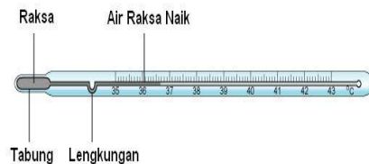
Gambar 1. Bagian-bagian Termometer Raksa
