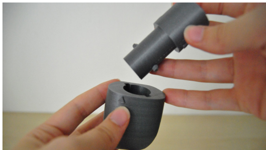
(3) Encaixar a peça interna à peça de baixo*
