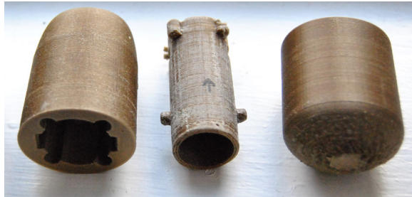
fig. 36 modelos impressos em 3D, protótipo em 3 peças
