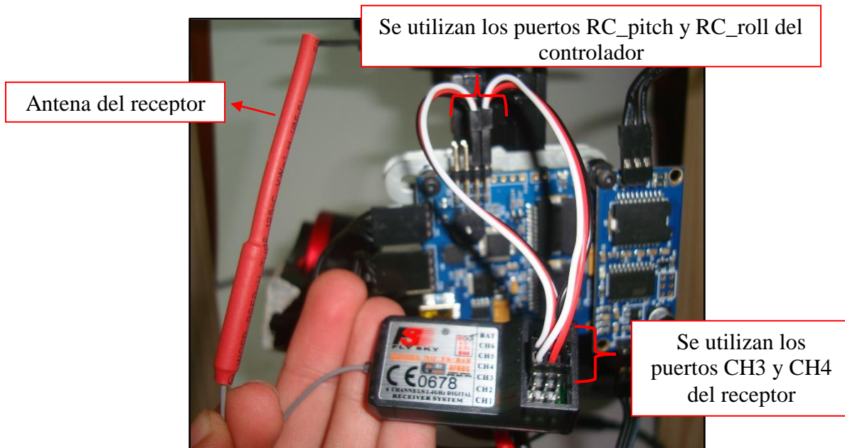
Figura 4.15 Conexión del receptor de radio frecuencia al controlador
