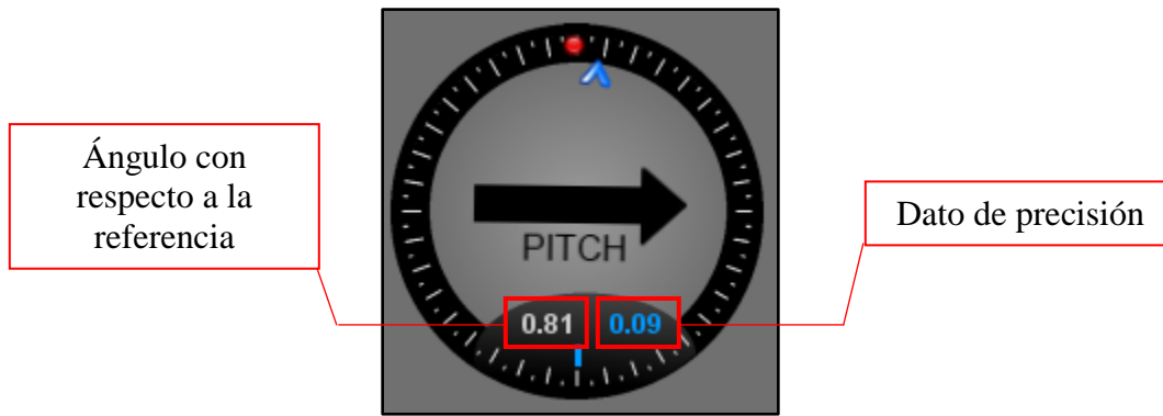
Figura 4.20 Desviación presente en el ángulo pitch para el caso de -90^\circ
