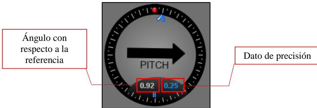
Figura 4.18 Desviación presente en el ángulo pitch para el caso de -45^\circ
