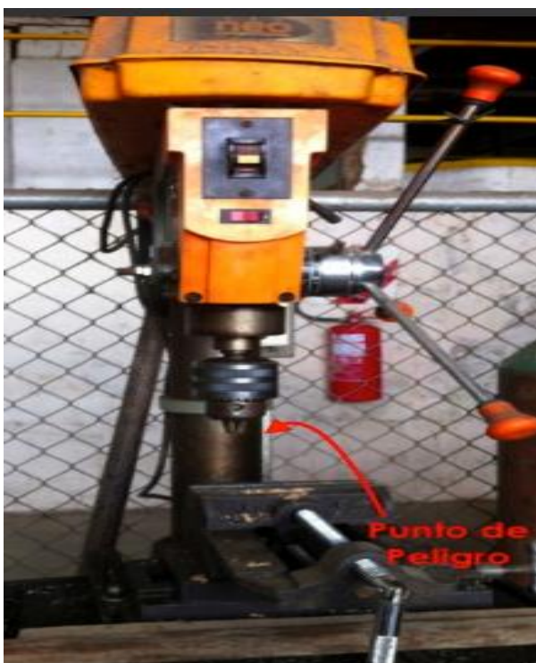
Figura IV-35: Ilustración del punto de peligro del Taladro de banco
