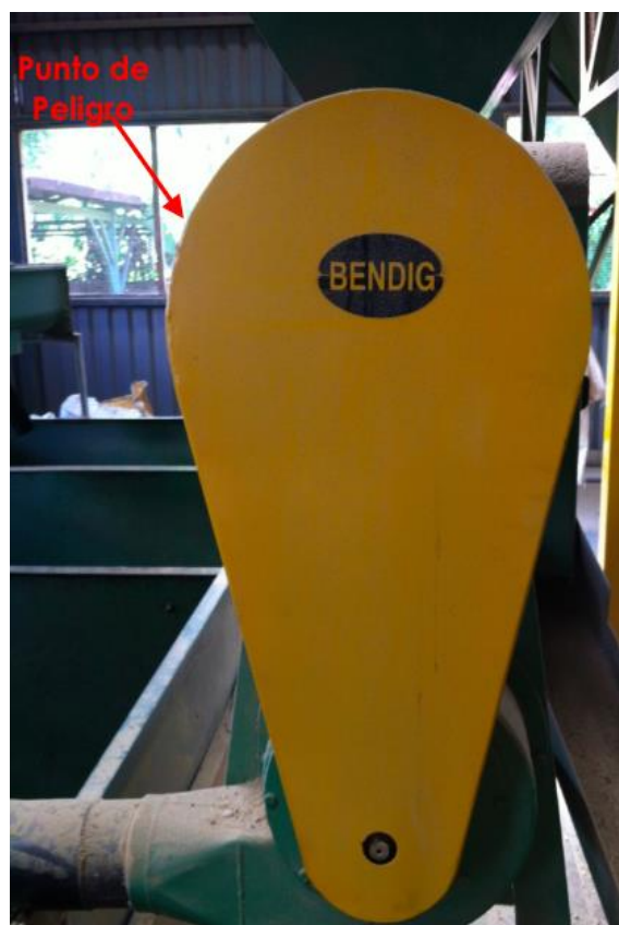
Figura IV-23: Ilustración del punto de peligro 4 de la Peladora
