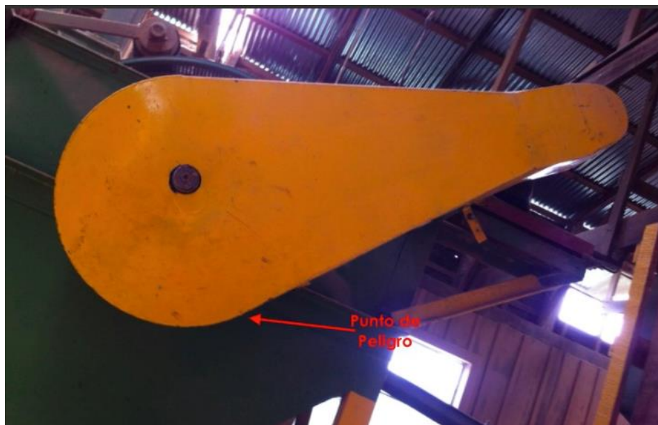
Figura IV-25: Ilustración del punto de peligro del Clasificador por forma de grano
