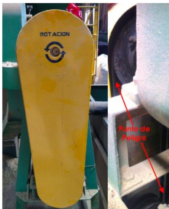
Figura IV-21: ilustración del punto de peligro 3 de la Peladora
