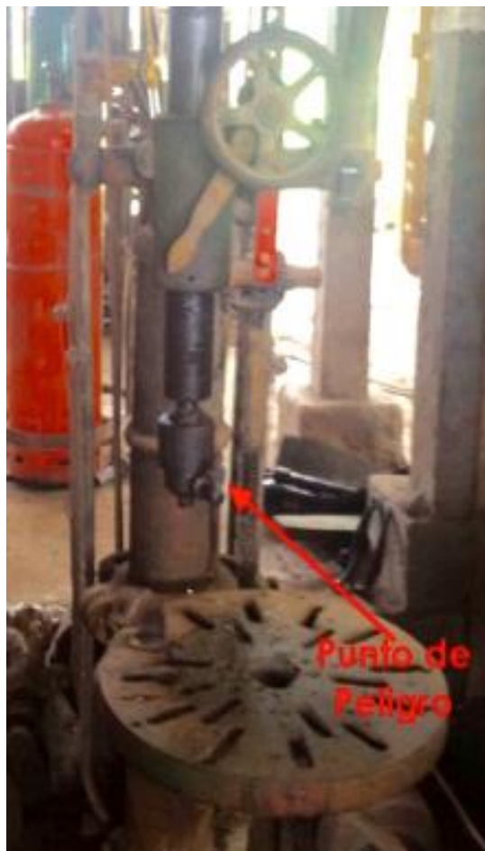
Figura IV-41 Ilustración del punto de peligro 3 del Taladro de Banco
