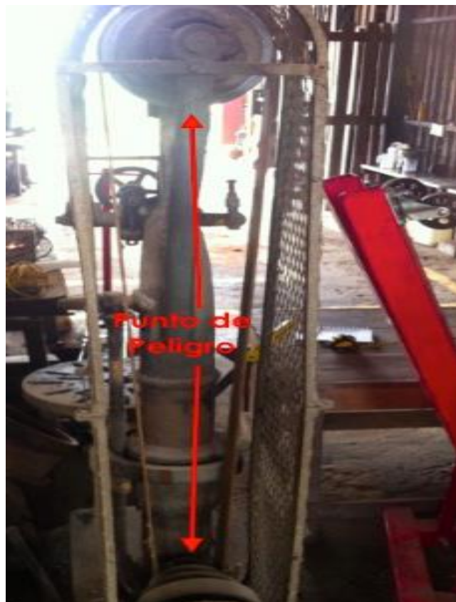
Figura IV-37: Ilustración del punto de peligro 1 del Taladro de banco
