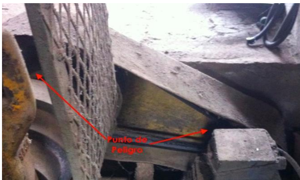
Figura IV-39: Ilustración del punto de peligro 2 del Taladro de banco
