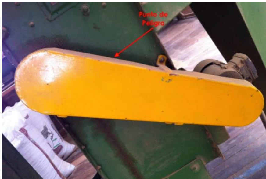
Figura IV-27: Ilustración del punto de peligro de la Catadora Bendig
