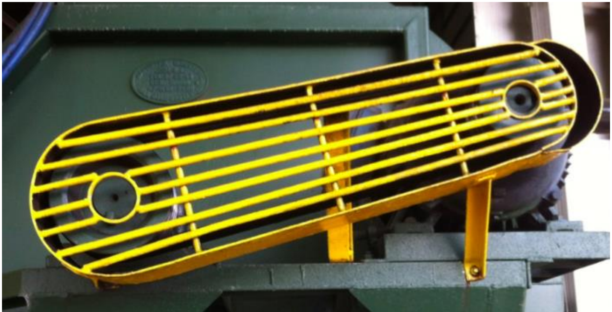
Figura IV-13: Ilustración del punto de peligro del Succionador
