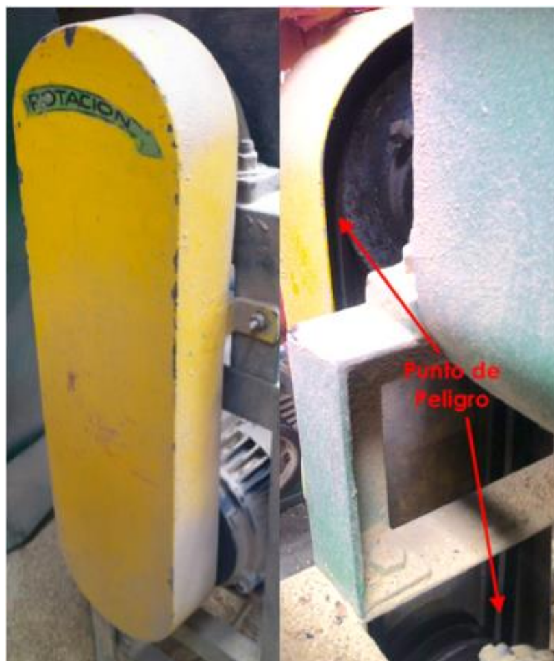
Figura IV-19: Ilustración del punto de peligro 2 de la Peladora
