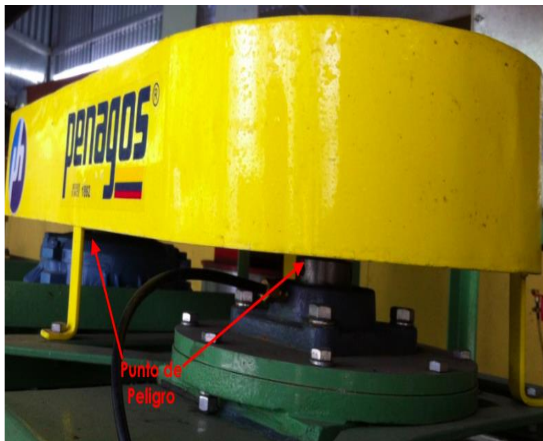
Figura IV-5: Ilustración del punto de peligro 1 de la Penagos
