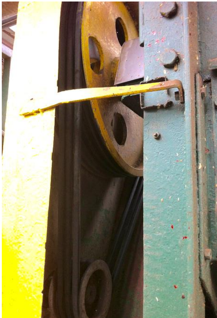
Figura IV-11: Ilustración del punto de peligro del Aguapulpa
