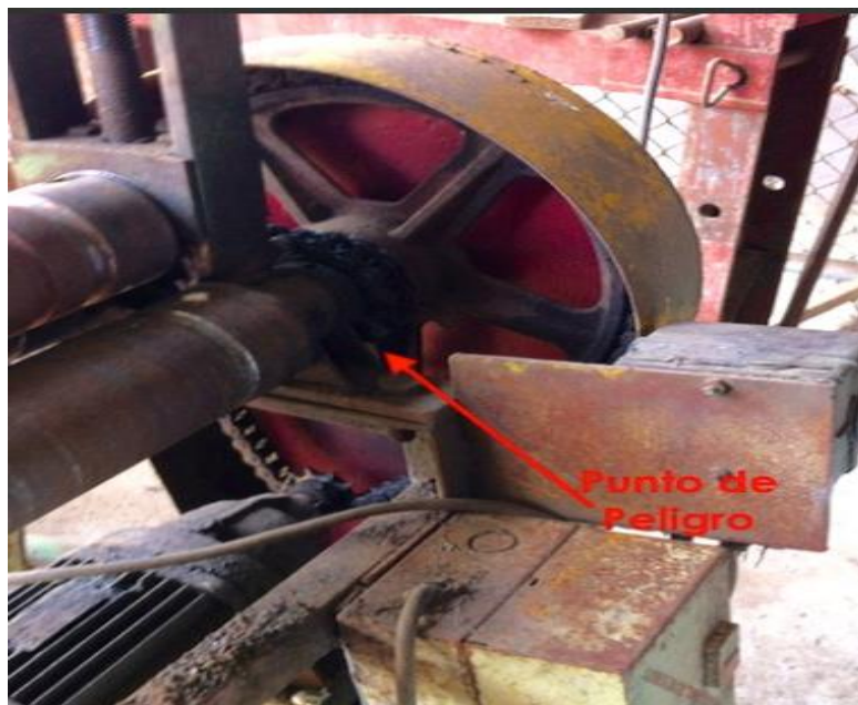
Figura IV-33: Ilustración del punto de peligro de la Roladora
