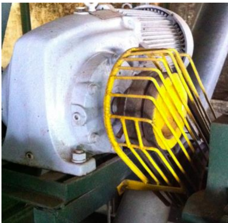
Figura IV-3: Ilustración del punto de peligro del Despulpador
