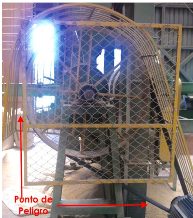
Figura IV-17: Ilustración del punto de peligro 1 de la Peladora
