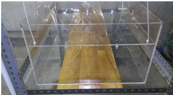
**Figura 20.** Bandeja fabricada para el simulador hidrogeológico. (Autor)
