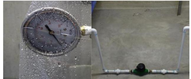
**Figura 21.** Manómetro de 100 psi y fluxómetro utilizado en el simulador hidrogeológico. (Autor)
