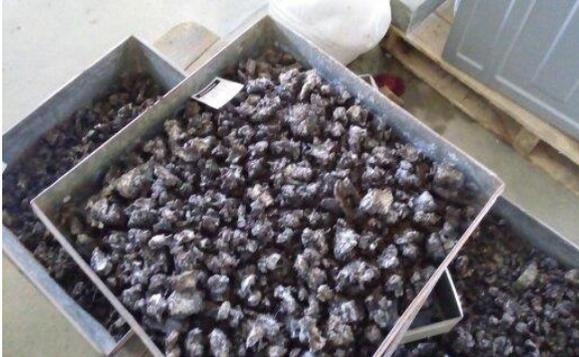
**Figura 5.** Material secado el horno durante cuatro días y medio a 60° Celsius. (Autor)
