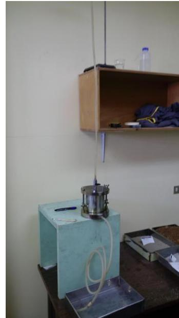
**Figura 17.** Montaje de la prueba de permeabilidad. (Autor)
