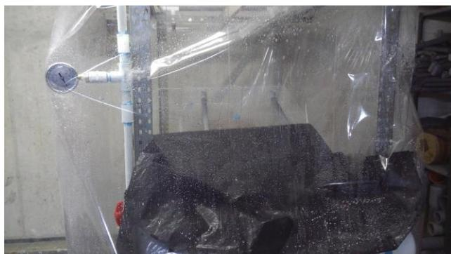
**Figura 31.** Bandeja cubierta mientras se estabiliza la presión en el sistema.
