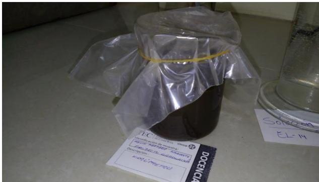
**Figura 11.** Muestra de 50 g de material disuelto en 125 ml de agente dispersador, en reposo por 16 horas. (Autor)
