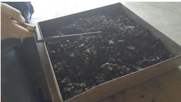
**Figura 28.** Material homogenizado con la humedad deseada. (Autor)
