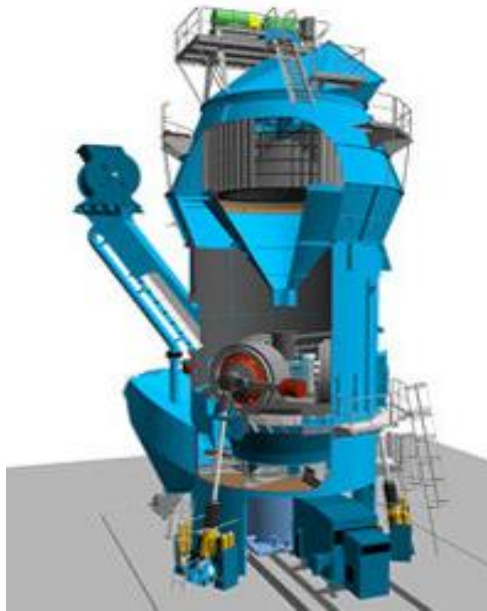
Figura 6.1.1. Molino vertical de rodillos. Imagen con fines ilustrativos.
