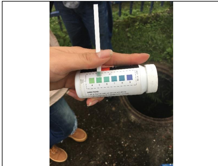
Fotografía 19: Determinación de pH en campo.
