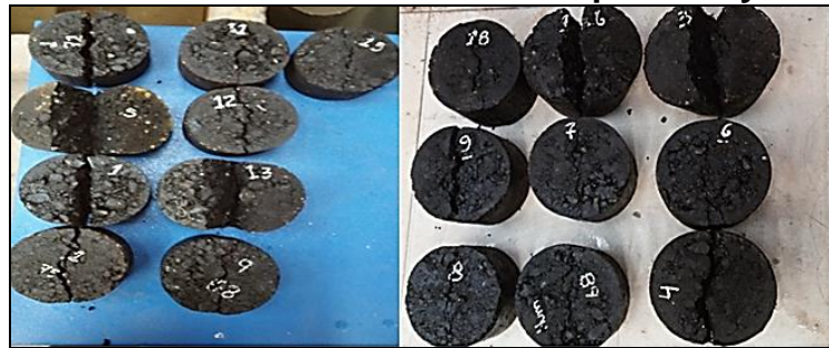
Figura 22. Evaluación de Falla a un Grupo Seco y Saturado
