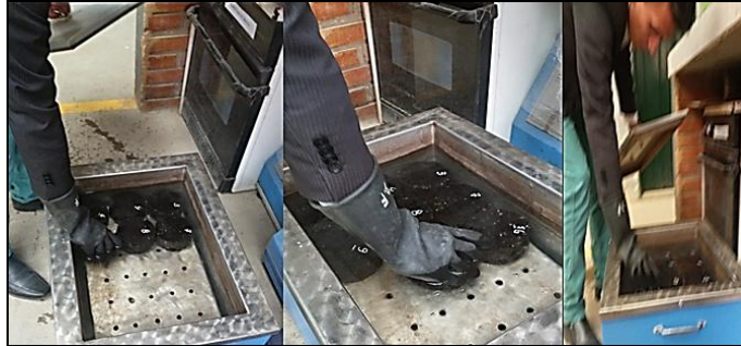
Figura 19. Sub-grupo de Probetas Llevadas a Inmersión
