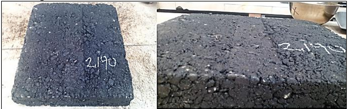
Figura 15. Marca de Ahuellamiento en Probeta Critica 90% Gmm
