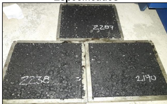
Figura 12. Probetas para Ensayo de Pista a los Grados de Compactación Especificados
