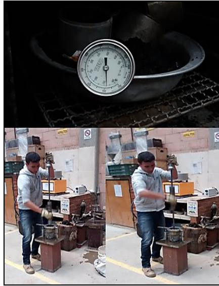
Figura 17. Compactación en Equipo Marshall
