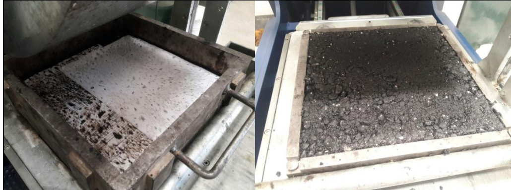
Figura 10. Molde para Compactación de Probetas de Pista
